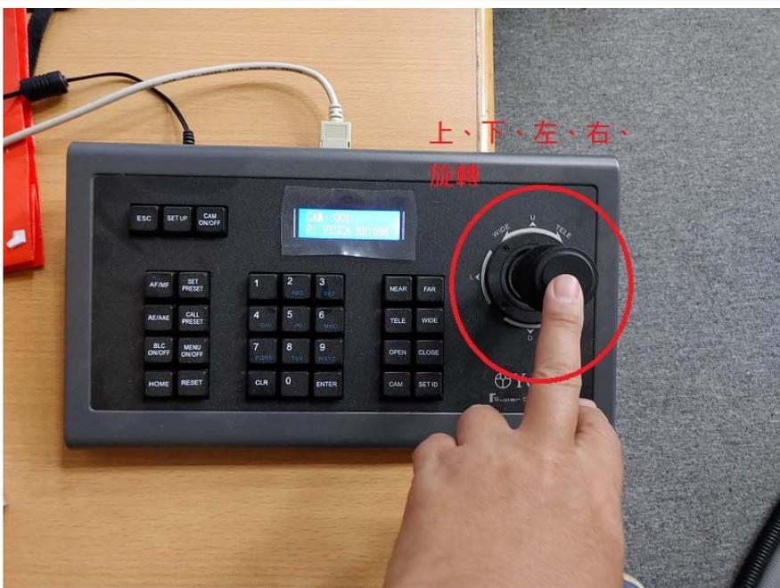
38. 攝影機遙控器可上、下、左、右、旋轉(拉近拉遠)控制
