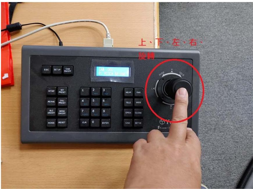
42.攝影機遙控器可上、下、左、右、旋轉(拉近拉遠)控制
