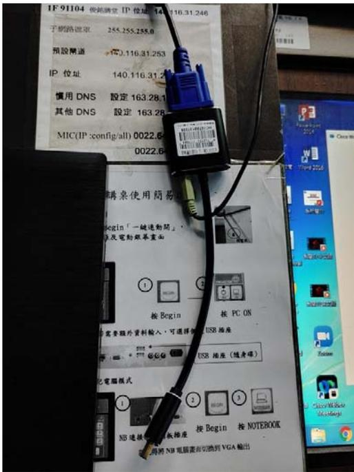
43.講台提供外接筆電訊號來源為 D-Sub，加上音源線，最終端為 HDMI
